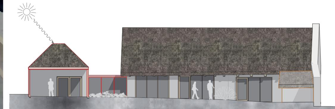
Schwarz: bestehende Struktur Rot: neue Struktur Gelb: abzureißende Struktur
